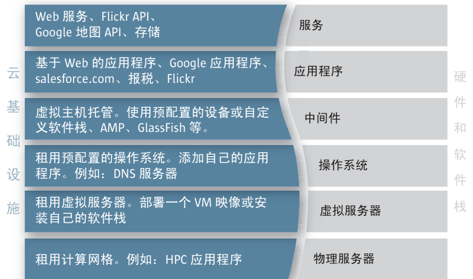
图 6. 云计算意味着把 IT 基础设施用作一项服务，而且该服务可以从租用原始硬件到使用第三方 API 的任何事情。
