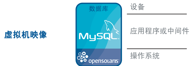
图 2. 可以通过把开放源软件层叠在一个虚拟机映像之中，并执行简化其部署的自定义，来创建设备。在此示例中，通过把 MySQL 软件层叠在 OpenSolaris 操作系统上来创建一个数据库设备。
