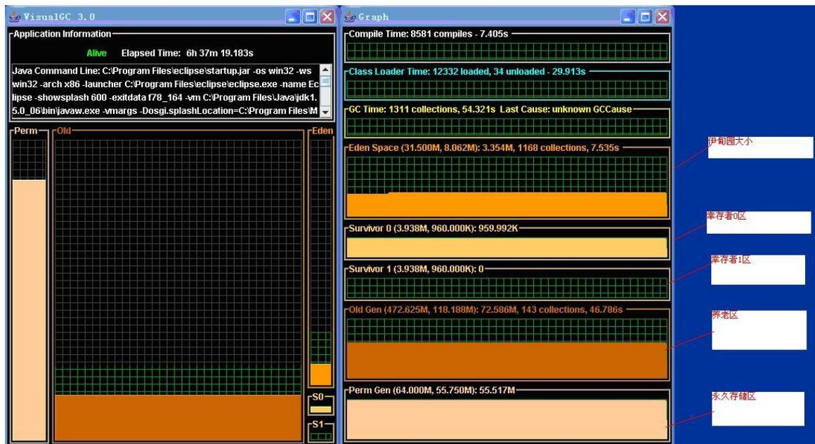
上图分别标注了伊甸园，幸存者 0 区，幸存者 1 区，养老区和永久存储区。图上直观的反应出各存储区的大小，已经使用的大小，剩下的空间大小，并用数字标出了各区的大小；如果你这上面的数字和你设置的 JVM 参数相同的话，那么恭喜你，你设置的参数已经起作用，如果和你设置的不一致的话，那么你设置的参数没有起作用（可能是服务器的启动方式没有载入你的 JVM 参数设置。）在优化服务器的时候，这个工具很有用，他占用资源少。可以随应用服务器一直保持开启状态，如果系统发生内存溢出，可以一眼就看出是哪个区发生了溢出。根据观察结果进行进一步优化。
