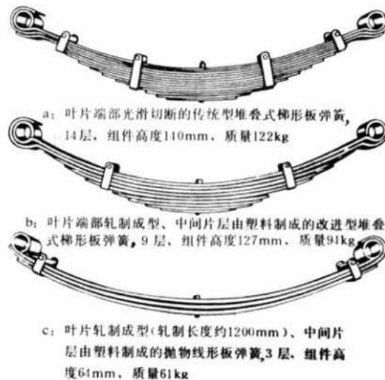
图 4.12 在各种载货汽车后悬架上采用的具有相同参数（两卷耳中心距 L=1650\text{mm} ，弹簧刚度 c_h=200\text{N/mm} 和预压力 F_w=33\text{KN} ）但设计构造不同的钢板弹簧。Krupp—Brüninghaus公司对它的质量大小进行了比较分析。
