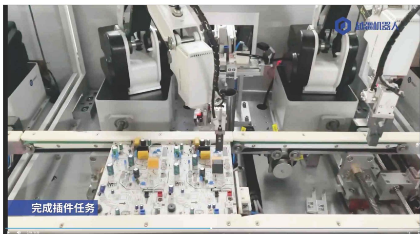
图 3.16: 空调主板自动化插件 [17]
