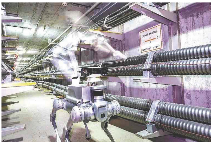
图 3.11: 电缆隧道机器狗巡检作业示意 [11]
