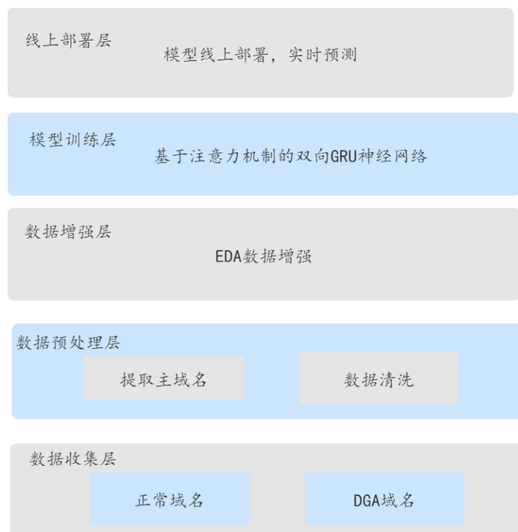
图 1 引入数据增强技术的智能 DGA 域名检测系统结构图
