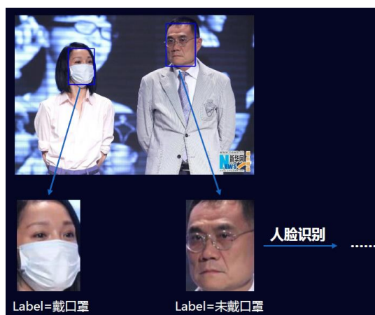
图 5 基于 MobileNet 轻量级分类网络判断是否戴口罩的测试效果
